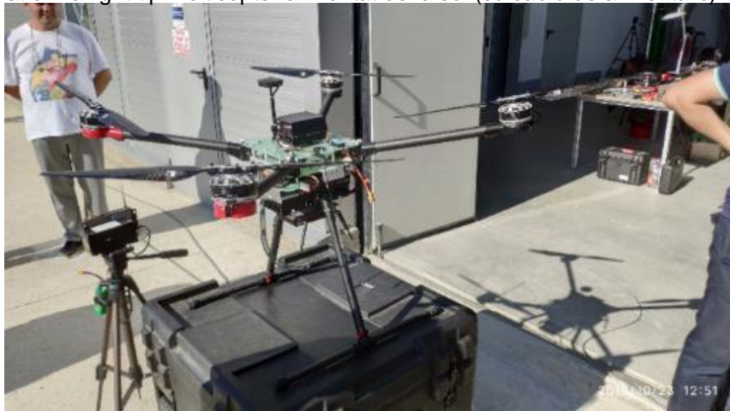
Platforma light tip multicopter alimentat de la sol (cu cablu de alimentare)
