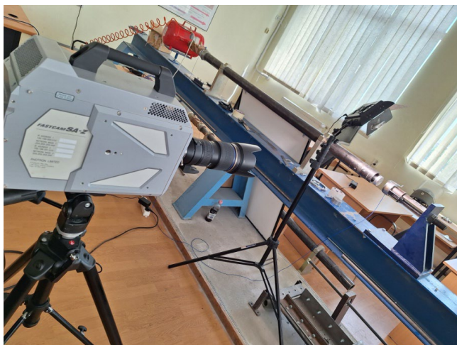
Fig. 28 Sistemul balistic cu aer comprimat
