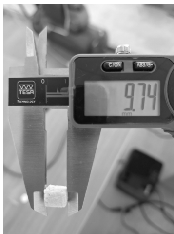
Fig. 27 Măsurarea dimensiunilor inițiale ale eșantioanelor
