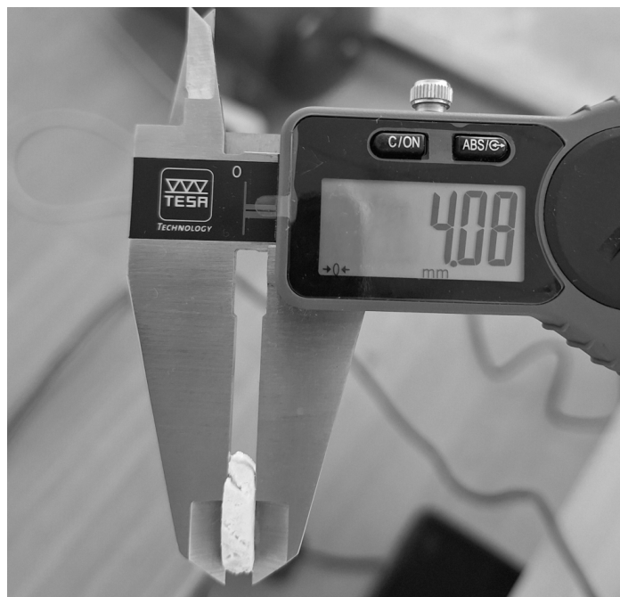
Fig. 30 Aspectul post-test al epruvetei din testul nr. 3 cu fisuri evidente pe suprafețele laterale, orientate oblic
