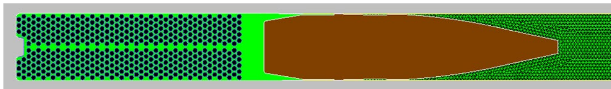
Fig. 8 Discretizarea modelului echivalent analizat – detaliu în zona proiectilului
