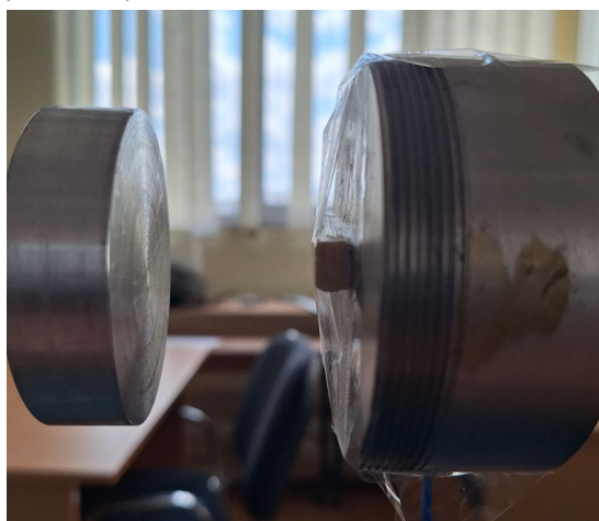
Fig. 29 Eșantion paralelipipedic amplasat pe suprafața de impact a țintei
